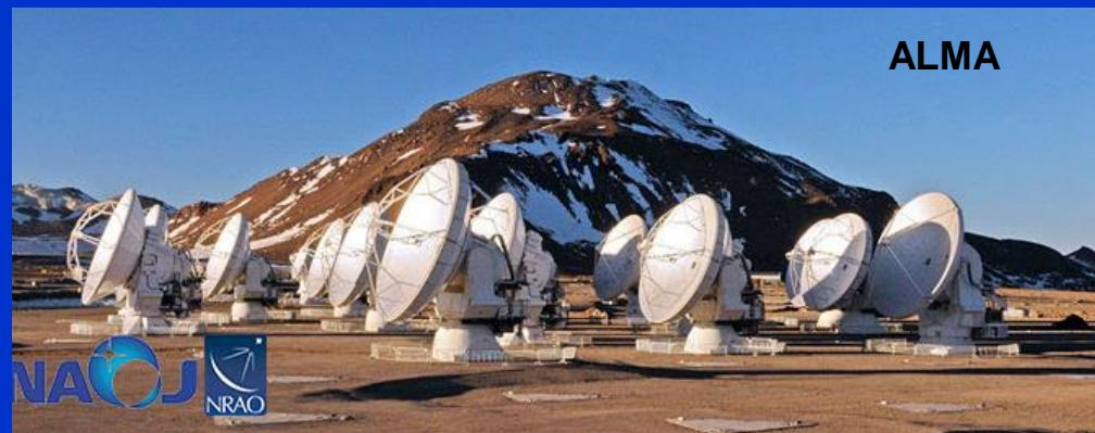
Le radiotélescope ALMA est un interféromètre constitué de 66 antennes (54 de 12 m de diamètre et 12 de 7 m de diamètre) dont l'espacement est compris entre 16 km et 160 m. Il est installée sur le haut plateau de Chajnantor dans le désert d'Atacama au Chili à 5 100 m d'altitude, pour l'observation des ondes millimétriques et submillimétriques des nuages moléculaires dans lesquels naissent les étoiles.
