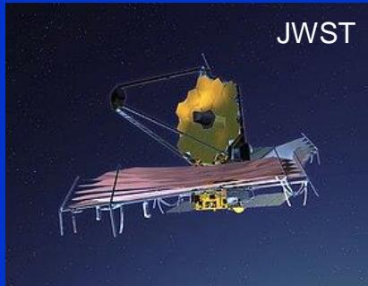
Le **télescope spatial James Webb (JWST)** fonctionnant principalement dans l'infrarouge, est conçu pour poursuivre les travaux du télescope spatial Hubble. La taille de son miroir primaire est de 6,5 m de diamètre contre 2,4 m pour Hubble, et son pouvoir de résolution atteint 0,1 seconde d'arc. Le JWST a été lancé depuis le Centre Spatial de Kourou le 25 décembre 2021 par une fusée Ariane 5 ECA et se trouve à 1.5 millions de km de la Terre.
