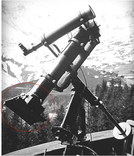
Le prisme objectif mis en place pour les observations stellaires à Arosa en 1933 ou 34
