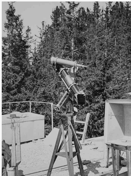
Le prisme objectif mis en place pour les observations stellaires à Arosa en 1933 ou 34
